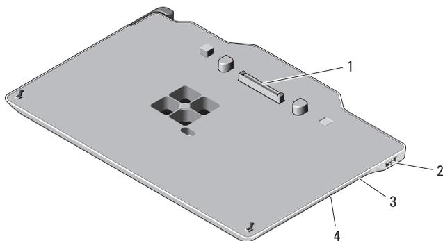
1 conector de acoplamiento
